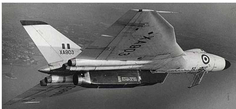
Avro 698 " Vulcan " B Mk1 serial XA903 lors des essais de pulvérisation d'eau (1971) avec une grille de vaporisation installée sous le fuselage avant pour les essais de dégivrage du moteur et de l'entrée d'air. (© MoD)
