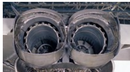
Tuyère secondaire convergente-divergente
