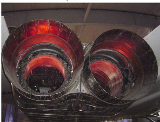
Ensemble d'éjection type 11. Inversion par 2 paupières et 10 grilles. La tuyère secondaire comporte 20 volets dits froids.
