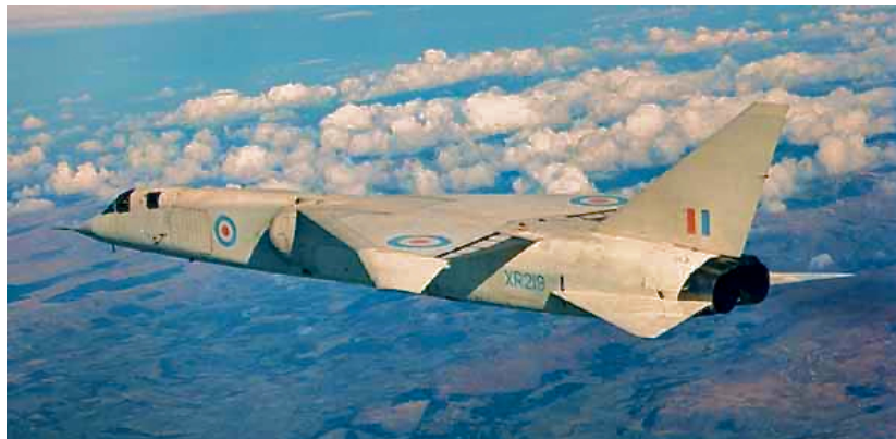
English Electric TSR-2 codé XR219 (1965) conçu pour voler à la fois " très haut, très bas, très vite et très loin ". Au niveau de l'entrée d'air et à l'instar des Mirage, le biréacteur utilisait un système de souris ou cônes mobiles. (Copyright MoD)
