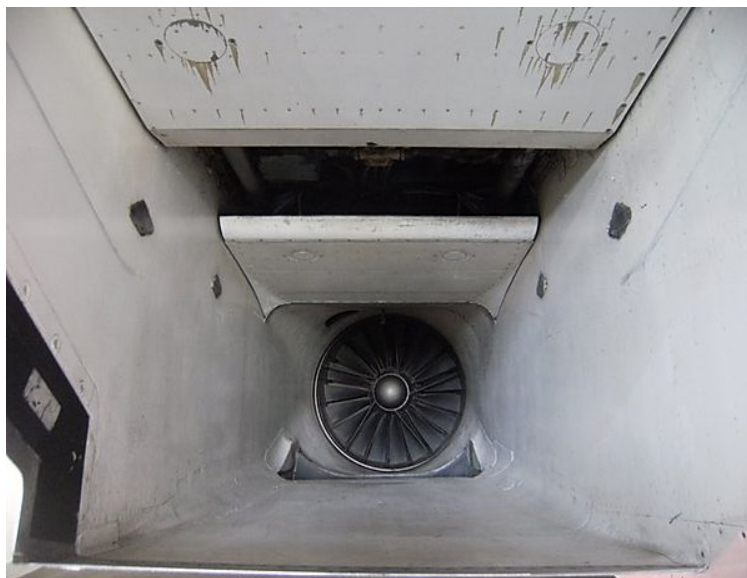
Entrée d'air à géométrie variable.
