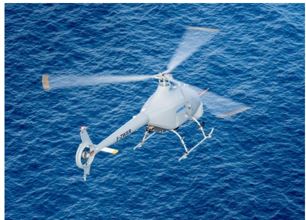
Le VSR700 est un drone multirôle, dérivé de l'hélicoptère biplace Cabri G2 d'Hélicoptères Guimbal. © Airbus Helicopters
