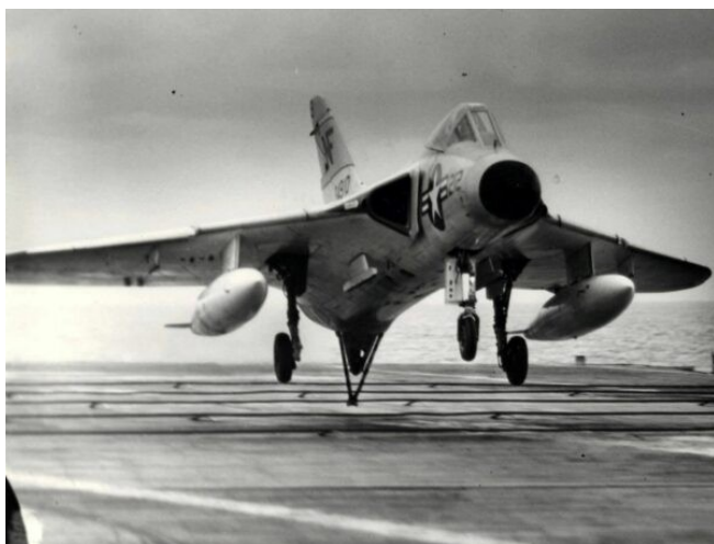
En lien avec son aérodynamisme « originale », le Skyray était très sensible aux turbulences de sillage des porte-avions et donc délicat à apponter.
