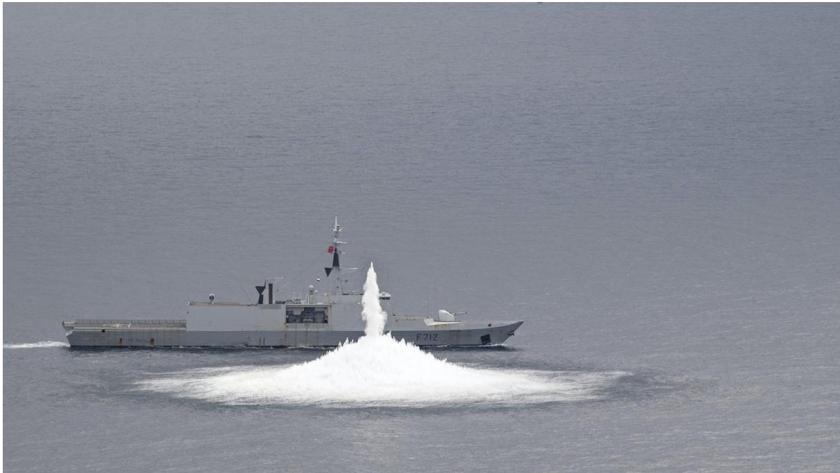
Le 25 février, au large de Toulon, l'équipage de la frégate de type La Fayette *Courbet* a été au cœur d'une expérimentation visant à éprouver sa résistance lors d'une explosion : un essai de choc. Réalisé en mer, il a permis d'éprouver la résistance d'un bâtiment de combat lors d'une explosion.
